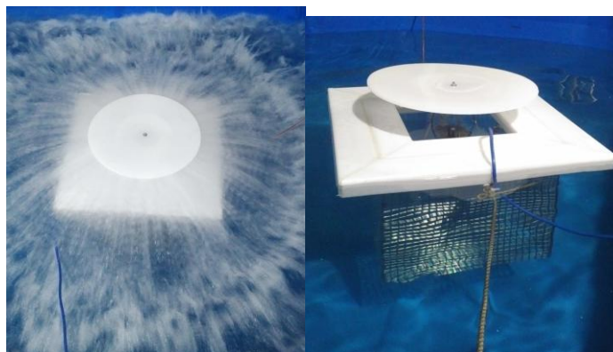
Рис. 2. Аэратор Поток-Фонтан с защитной сеткой в работающем (слева) и в отключенном положении.
